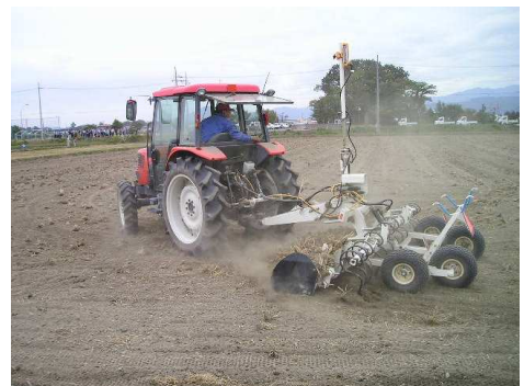
写真V-3-1 レーザー均平機作業
