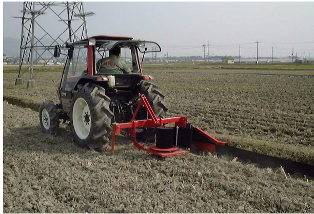
写真Ⅱ-5-12 あぜ波シート張り機による作業
